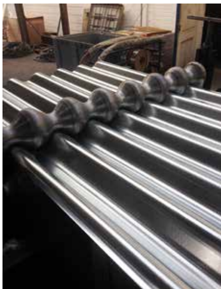
Speciale toegbank voor de staalplaten met een golf van 40 mm hoog en 160 mm lang.
